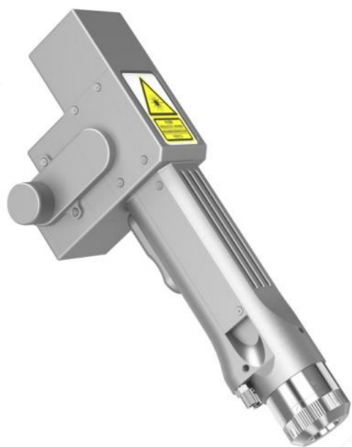
清洗头的焦距为400mm/800mm, 光纤长度为10m/15m, 清洗宽度为10mm-300mm
